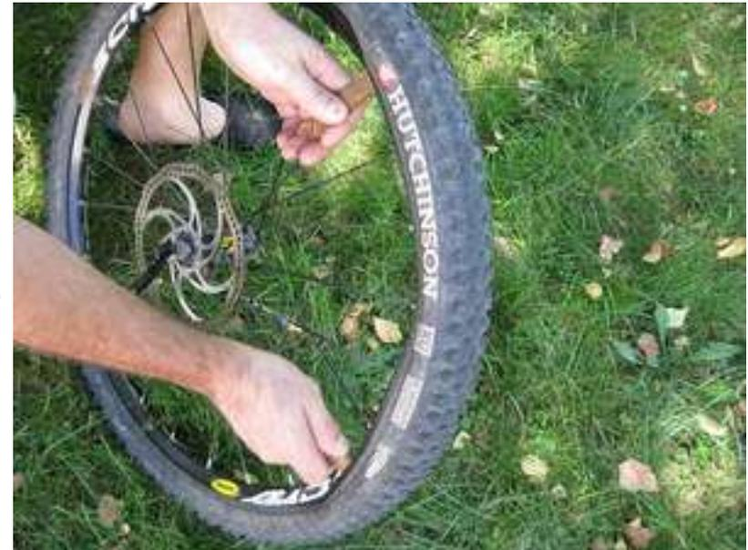
Une fois le démontage amorcer déplacer le second démonte-pneu le long de la jante
