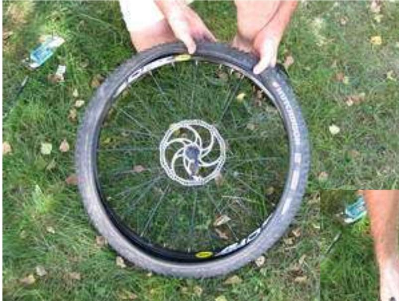
Une fois la chambre entièrement logée dans le pneu, remettre en place le pneu en commençant par le côté de la valve, puis progresser le long de la roue jusqu'à ce que le pneu soit entièrement mis en place
