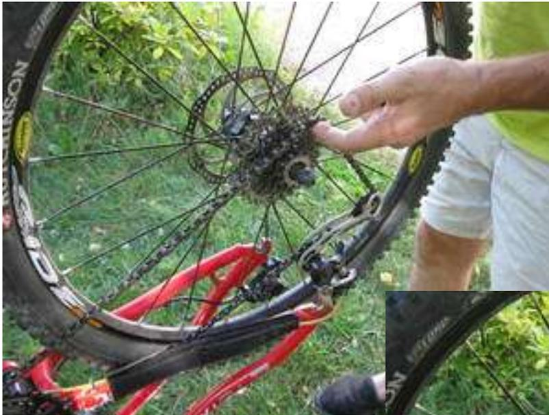
Pour la roue arrière, positionner la chaîne sur un des petits pignons, puis faire basculer le dérailleur vers vous, tout en rapprochant l'axe de la roue de sa position sur le cadre.
