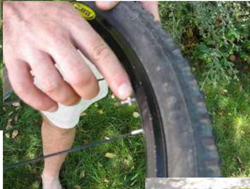
Déposer l'écrou de maintien de la valve
