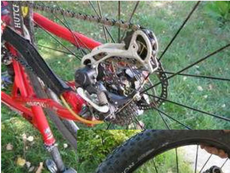
Le cas échéant manœuvrer le dérailleur AR tout en tournant les pédales afin de positionner la chaîne sur un des petits pignons
