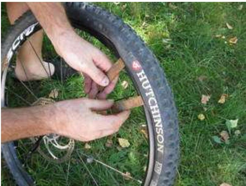
Objectif, à l'aide des démonte-pneus faire passer le flan du pneu au dessus du bord de jante
