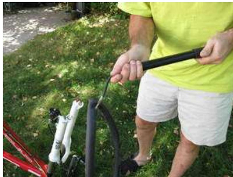
Pour localiser un trou le mieux c'est de plonger la chambre dans de l'eau, à défaut c'est au bruit et ou au souffle d'air sur la joue que l'on procédera à la localisation.
