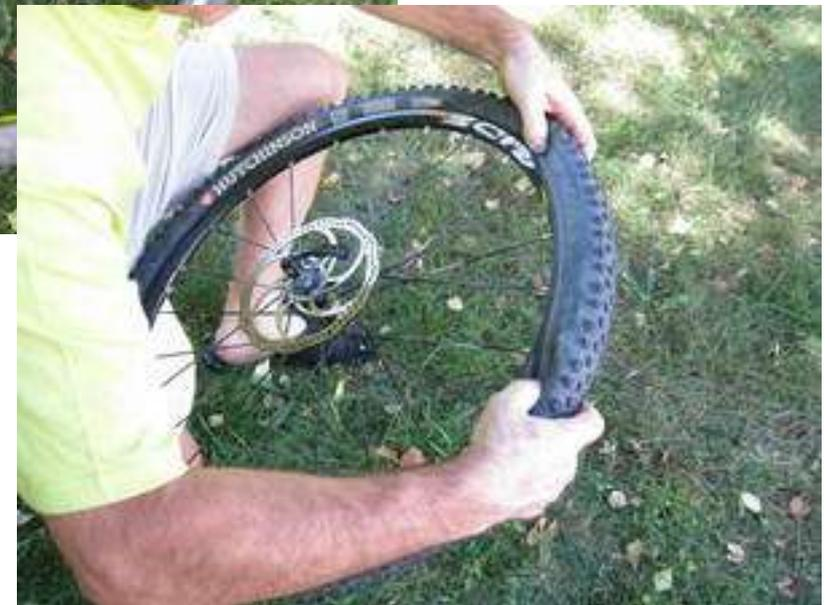
Normalement on doit pouvoir remettre le pneu sans outil mais il n'est pas interdit d'utiliser un démonte-pneu sous réserve de ne pas pincer la chambre :-)
