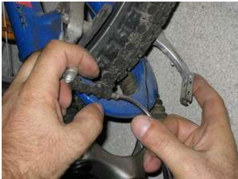
Pour les vélos équipés de V-Brakes, remettre en place le coude sur l'étrier de frein, et impérativement contrôler le freinage avant de poursuivre votre chemin!
