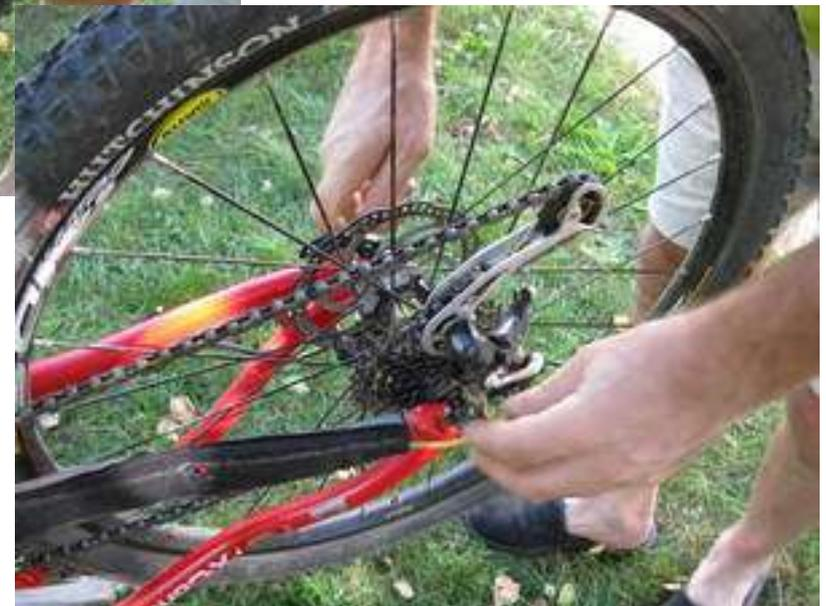
La roue en place, procéder au verrouillage de l'axe via le levier de serrage.
